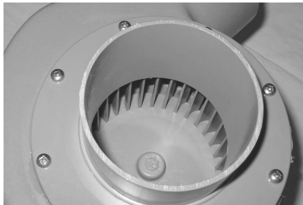
Ventilatorhjulets udformning med tætsiddende fremadkrummede skovle sikrer en flad karakteristisk og en høj ydelse på trods af de små dimensioner.
